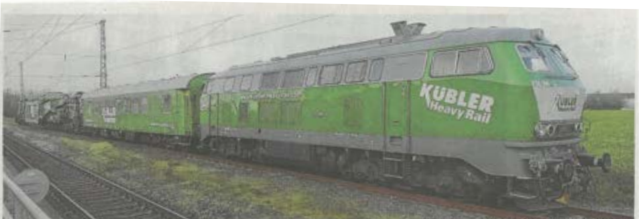
Zwischen 1968 und 1979 wurden die Lokomotiven der Baureihe 218 produziert, zumeist in der Farbe Rot. Die eigenen beiden Loks hat die Spedition Kübler in der Unternehmensfarbe Grün neu gestaltet. Angehängt sind ein Begleitwagen und dahinter der 24-achsige Tragschnabelwagen. Dieser hat einen mehrere Hundert Tonnen schweren Trafo geladen. Wegen des enormen Gewichts darf der Transport nicht schneller als 40 km/h fahren. Fotos: Spedition Kübler
